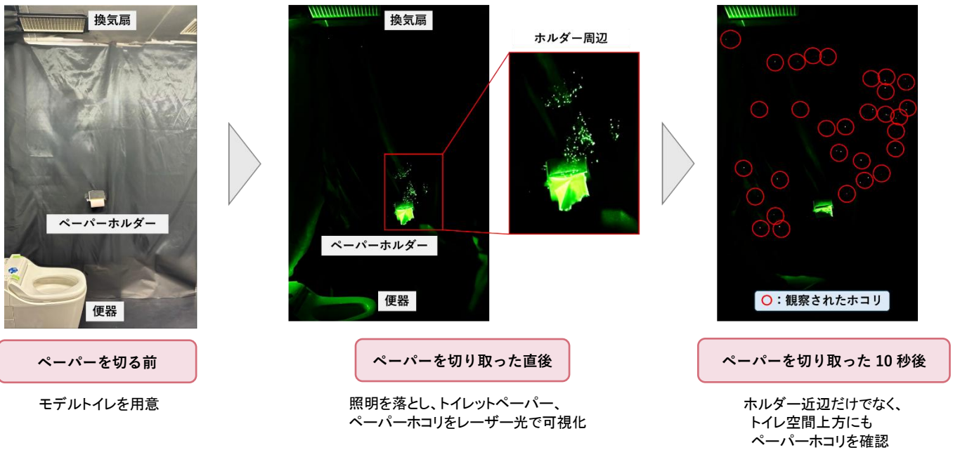
図4. トイレットペーパー使用時に飛散するペーパーホコリの様子
