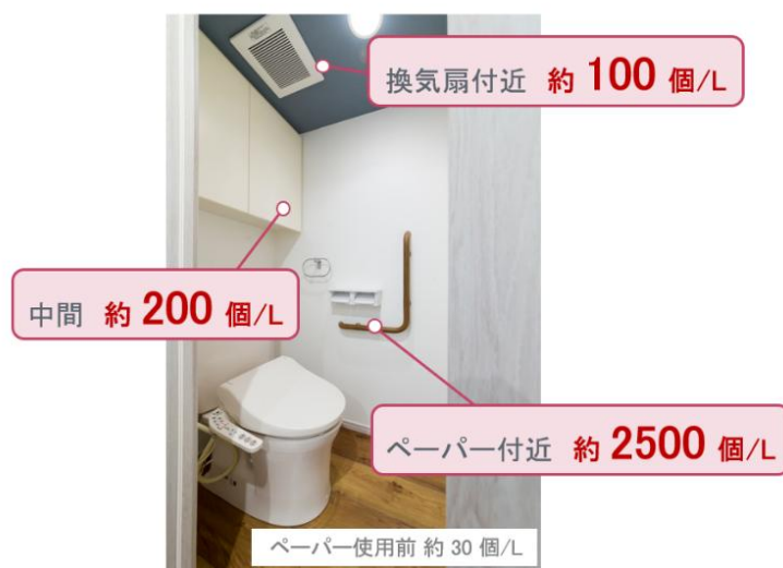
図1. トイレトーパー使用時に飛散するペーパーホコリの分布
